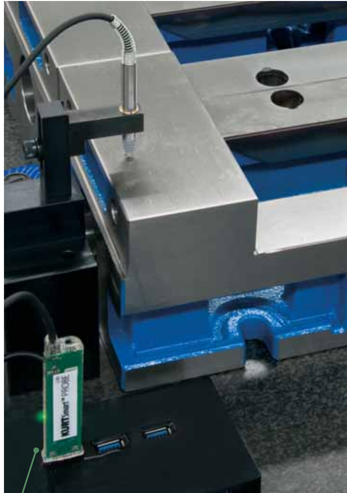
El LED indica si la parte está bien (verde), tendiendo a mal (amarillo), o mal (rojo).
