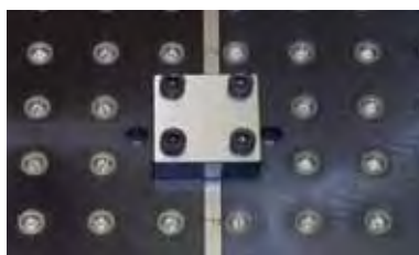
Mostrando Block Localizador conectando dos placas perforadas. Parte No. TP400102 Bloque Localizador (1) Parte No. TP400102-SC Tornillos (4)
