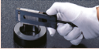
Inspeccionando un agujero usando un par de limitadores semi cilíndricos y un sujetador
