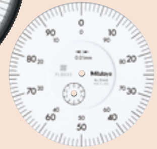
Graduación: 0.01mm Intervalo de medición: 10mm
