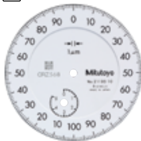
Graduación: 0.001mm Intervalo de medición: 5mm Tipo de cojinetes enjovados
