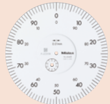
Graduación: 0.01mm Intervalo de medición: 10mm
