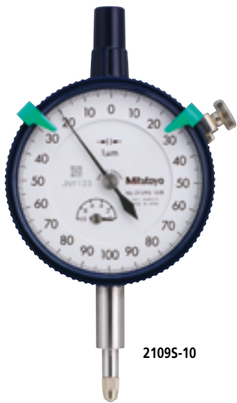
Graduación: 0.001mm Intervalo de medición: 1mm Tipo a prueba de impacto Tipo de cojinetes enjovados
