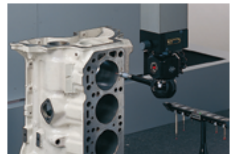
▲ Ejemplo de montaje de palpador de activación por contacto
