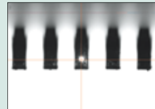
Ejemplo de aplicación: Altura de terminales en un paquete QFP
