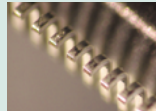
Ejemplo de aplicación: Altura de terminales en un paquete QFP
