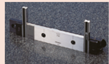
Uso de conectores tipo B en la construcción de un calibre
