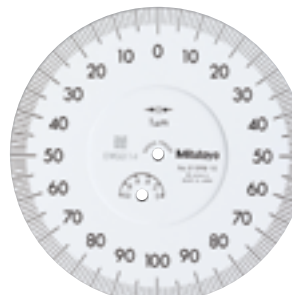
Graduación: 0.001mm Intervalo de medición: 1mm
