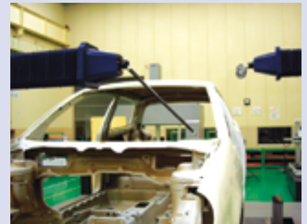
Ejemplo de medición tipo dual (Equipado con palpador de contacto y palpador de línea láser)
