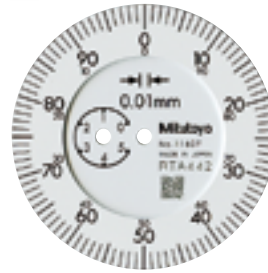
Graduación: 0.01mm Intervalo de medición: 5mm
