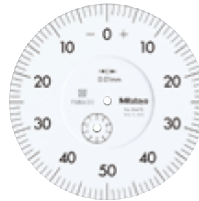
Graduación: 0.01mm Intervalo de medición: 10mm
