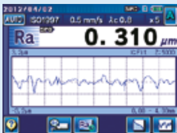
Muestra de perfil: Un resultado del parámetro de medición y el perfil evaluado.
