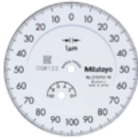
Graduación: 0.001mm Intervalo de medición: 1mm Tipo a prueba de impacto Tipo de cojinetes enjovados
