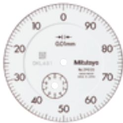
Graduación: 0.01mm Intervalo de medición: 10mm 29025
