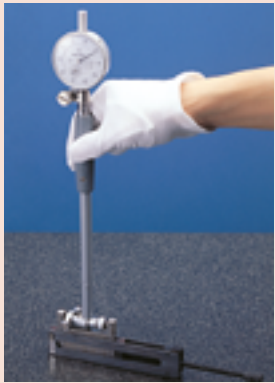
Fijando un medidor de agujeros usando un sujetador con el par de limitadores semi cilíndricos de tipo 1 usados como superficies planas de contacto
